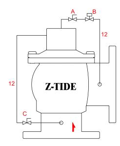
Pressure Adjusting Range :  $1 \sim 6 \text{ kgf/cm}^2$ ( 1 kgf/cm<sup>2</sup> = 14.2 psi)  $4 \sim 10 \text{ kgf/cm}^2$
